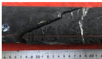
图3 构造成因高角度裂缝
